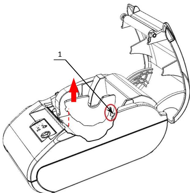
Рисунок 10. Извлечение фиксатора-защелки из паза в лотке ЧЛ
