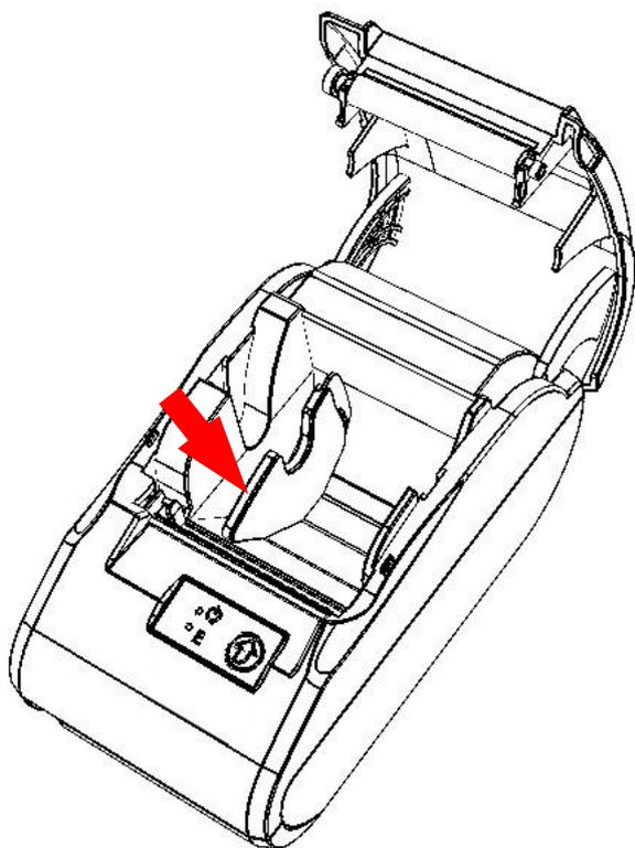
Рисунок 8. Направление приложения усилий при установке ограничителя
